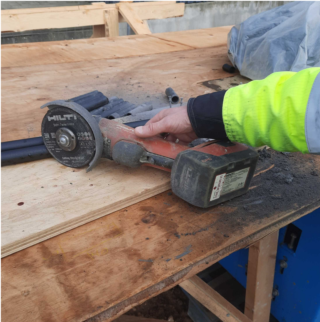
Billedet viser Hilti vinkelsliberen uden støttehåndtag, som den ansatte benytter med én hånd.
